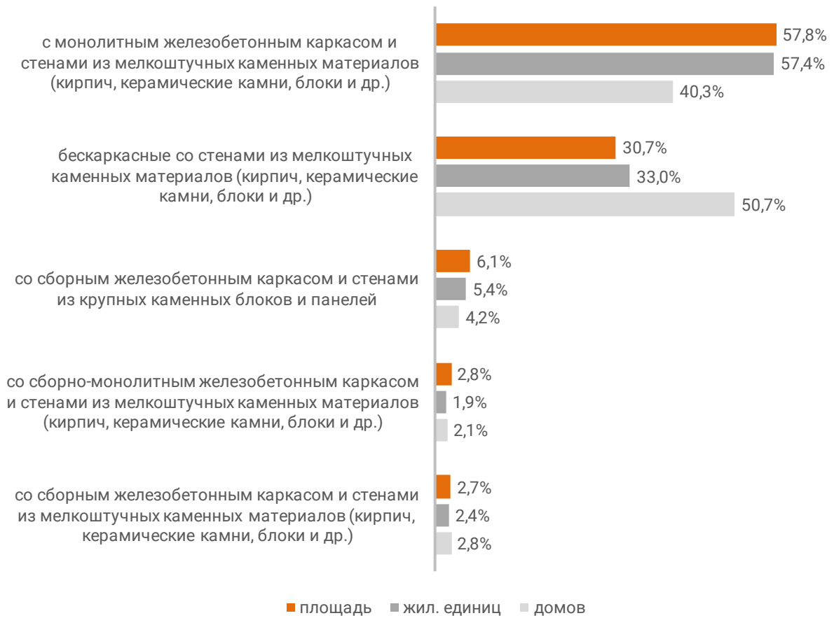
Распределение жилых новостроек Волгоградской области по материалам стен (по утвержденной форме ПД)
