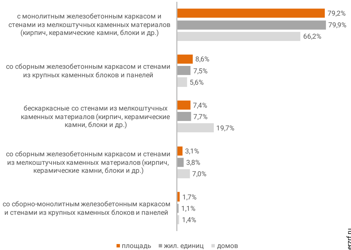
Распределение жилых новостроек Республики Адыгея по материалам стен (по утвержденной форме ПД)
