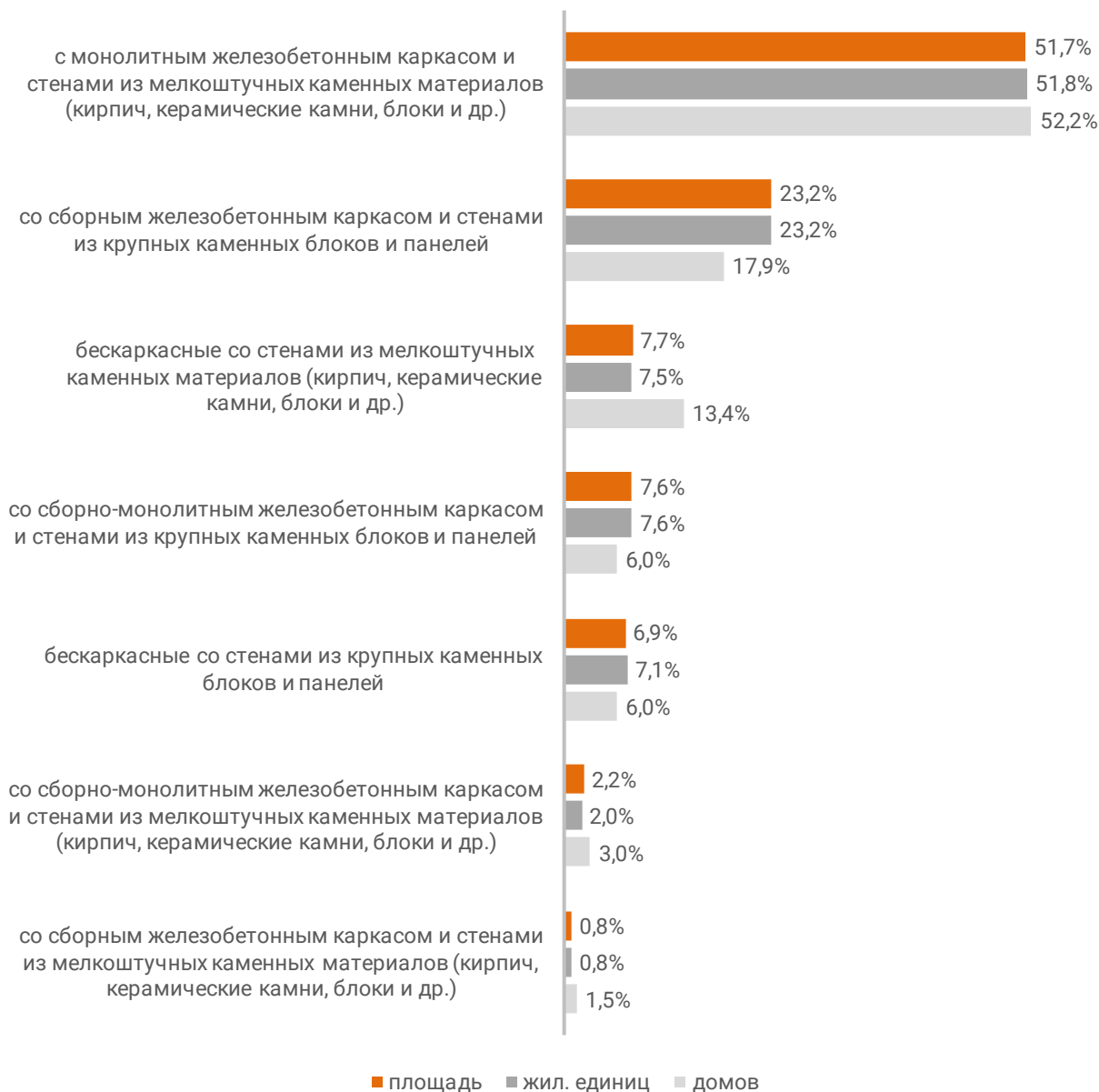
Распределение жилых новостроек Ханты-Мансийского автономного округа - Югра по материалам стен (по утвержденной форме ПД)
